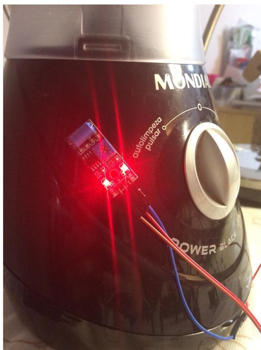
Figure 7: Sensor de Vibração SW 420 fixado ao liquidificador
